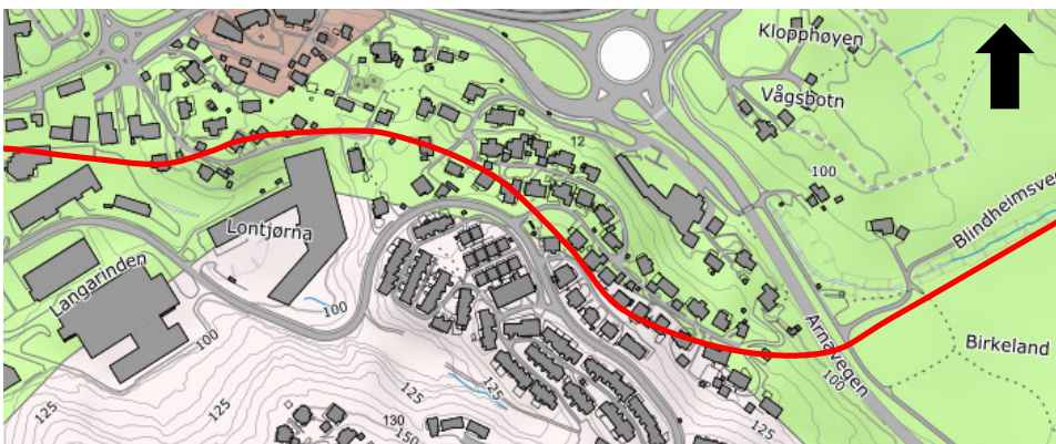
Figur 5. Delstrekning 4. Løsmassekart fra NGU med inntegnet trasé. Tynt morenelag i overflaten mot berg under (grønt område), berg i dagen (rosa) og torv eller myr (brunt). Tunnel mellom Tertneskrysset – Asane som vises i Figur 4 tilhører også delstrekning 4.
